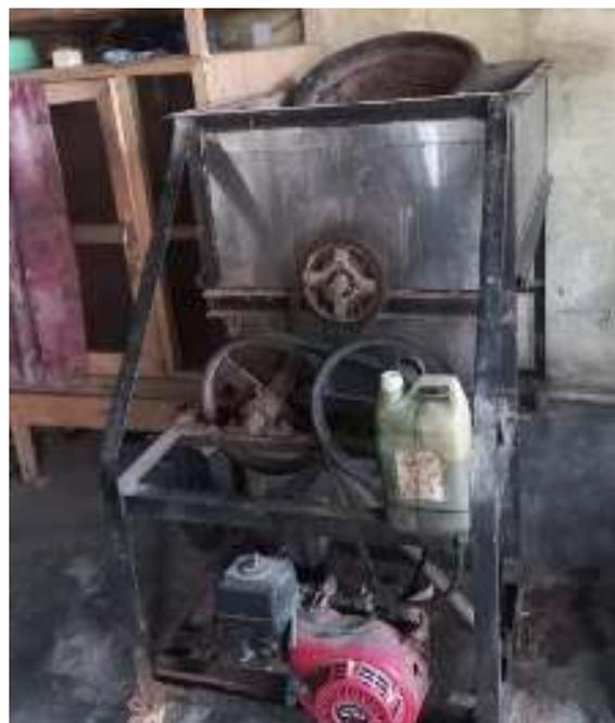
Gambar 1. Alat Pencampuran
